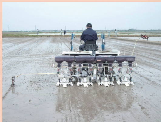
Trồng lúa áp dụng kỹ thuật gieo hạt trực tiếp (máy cấy mạ đa năng có gắn kèm máy gieo hạt)
